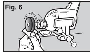
**REMARQUE:** Assurez-vous que Mandrel vis est solidement (mais ne pas trop serrer) ou il glissera comme une pression est appliquée à la roue, provoquant des frictions qui pourraient endommager le moyeu de la roue.
